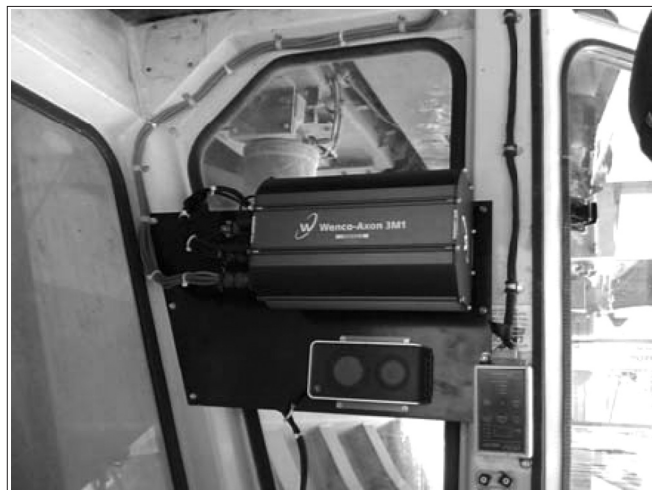
Рис. 2. Бортовой компьютер в кабине автосамосвала
