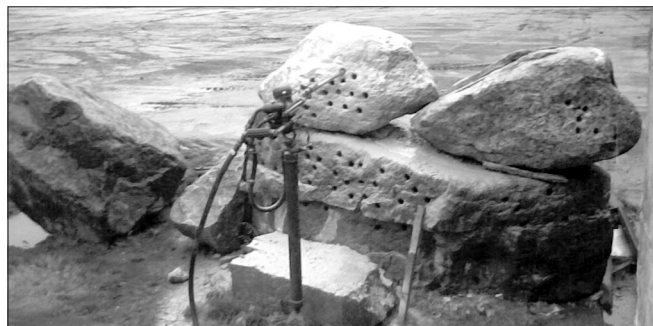
Рис. 2. Образцы апатито-нефелиновой руды с пробуренными шпурами и перфоратор на пневмоподдержке
