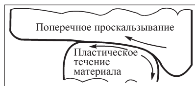
Рис. 4. Модель образования конформного гребневого контакта
